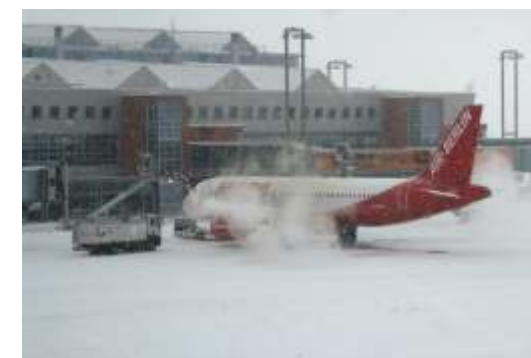
Fig. 2: De- icing of a plane (source: Flughafen Dresden GmbH)
